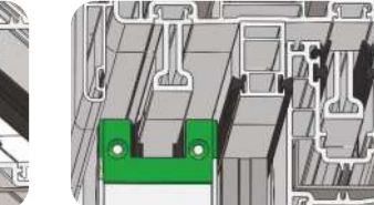
ÜST SÜRME KAPAĞI sayesinde sürme kanat kapamanın manuel olarak üst ray şeklinde kesilmesine gerek kalmadan estetik görünüm sağlanırken kapamanın raya sürme riski ortadan kaldırılmıştır.
