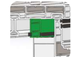
ÜST YALITIM PROFİLİ sayesinde, üst yatayda iki kanat arasında hava geçişi engellenmektedir.
